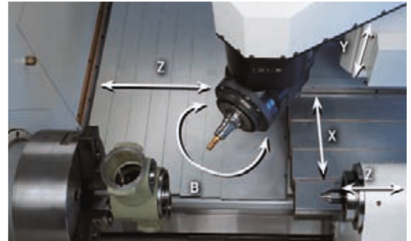
Bild 1: Motorfrässpindel FA. Monforts Maschinentyp UniCen
